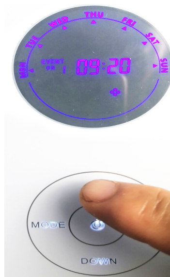
Step 7: press UP button till day flash
