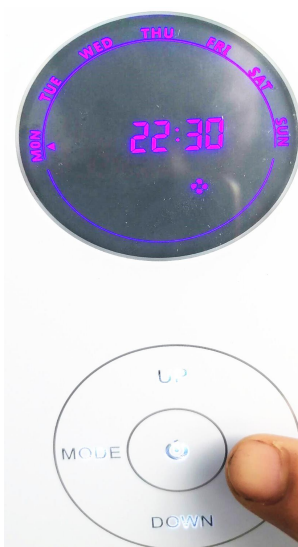
Step 5: press SET button till day flash
