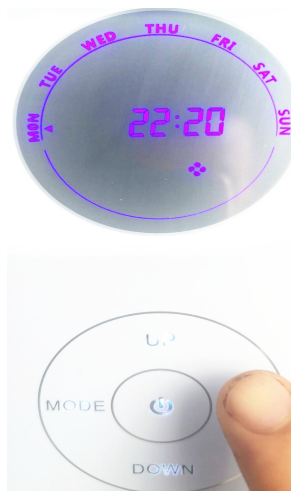
Step 3: press SET button till minutes flash
