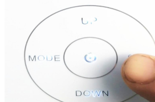
Step 4: press SET button till minutes flash
