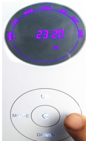
Step 1: press SET button till Hour flash
