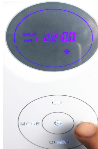
Step 2: press SET button till hour flash
